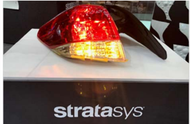
Vivid Color マテリアルと J750 でプリントされたテールランプのモデル。クリアレンズは Vivid Color(M,Y,Clear)で、内部パーツは VeroBlack、かつメッキ処理されています。名古屋 DMS で初展示される予定。
