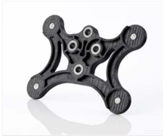
FDM Nylon 12CF の優れた機械的特性を備えているため、従来の金属パーツやジグを 3D プリントした樹脂部品への置き換えが可能。写真はドリル穴あけ用ジグ。
