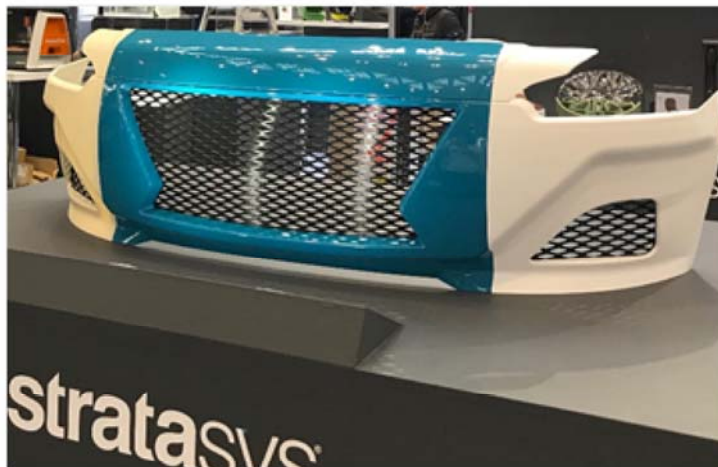
ストラタシスのハイエンド FDM 3D プリンタ Fortus900mc と高い強度と耐候性を兼ね備えた ASA 材料で造形された実寸サイズのバンパー。サーフェス処理や塗装など、用途にあわせて実製品と同様の仕上げ処理も施すことができ、機能試験などにも活用できる。
